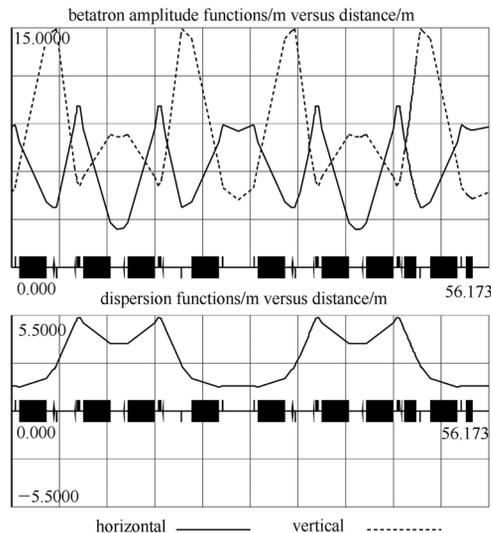
Figure 2: Twiss parameters of the synchrotron.
