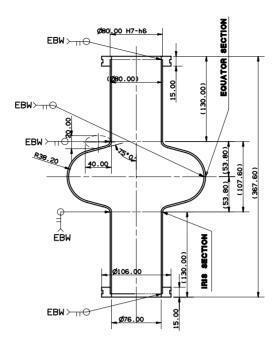
FREQUENCY : 1295.01(MHz) SHUNT IMPEDANCE ; Rsh/Q= 115(ohm)
