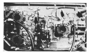
Fig. 4 : 100 W. amplifier module (plan view).
