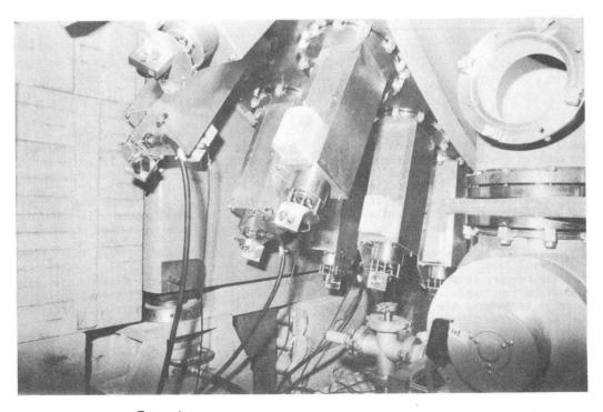
Fig. 4 PARTIAL VIEW OF THE MOTOR DRIVEN SLIT DEVICES
