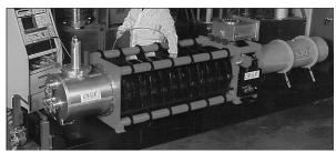
Figure 1: Picture of CPI 700 MHz klystron.
